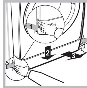
1. Îndepărtați panoul de acoperire de pe latura anterioară a mașinii, apăsând spre centru, apoi împingeți în jos de pe ambele laturi și scoateți-l (a se vedea figurile).
