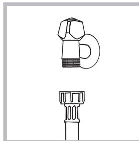
1. Conectați furtunul de alimentare, înșurubându-l la un robinet de apă rece cu gura filetată de l' gaz (a se vedea figura). Înainte de conectare, lăsați apa să curgă până când nu a devenit limpede.
