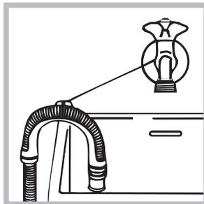
oder hängen Sie diesen in ein Becken oder eine Wanne ein; befestigen Sie den Schlauch in diesem Falle mittels der mitgelieferten Führung an dem Wasserhahn (siehe Abbildung). Das freie Ablaufschlauchende darf
