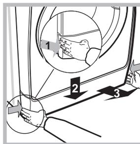
1. Odložte krycí panel na prednej strane zariadenia zatlačením na jeho stred a následným zatlačením smerom nadol z oboch strán a potom ho vytiahnite (vid' obrázky).
