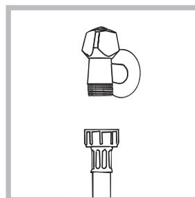
1. Pripojte prívodnú hadicu jej zaskrutkovaním ku kohútiku so studenou vodou, s hrdlom so závitom 3/4" (vid' obrázok). Pred pripojením hadice nechajte vodu odtečť, až kým nebude číra.
