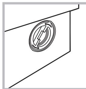
2. Odskrutkujte veko otáčaním proti smeru hodinových ručičiek (vid' obrázok): vytečenie malého množstva vody je úplne bežným javom;
