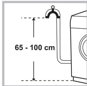
Conectați furtunul de evacuare, fără al îndoii, la o conductă sau la o gură de evacuare în zid, situate între 65 și 100 cm de pământ;
