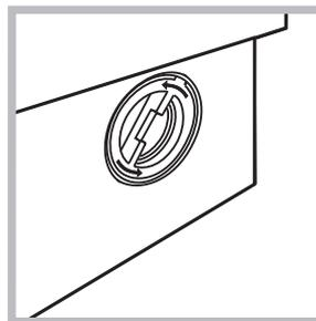
2. Odšroubujte víko jeho otáčením proti směru hodinových ručiček (viz obrázek): vytvoření malého množství vody je zcela běžným jevem;
