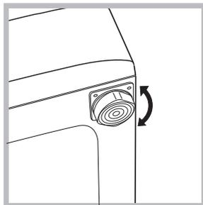
2. Dacă podeaua nu este perfect orizontală, compensați neregularitățile deșurubând sau înșurubând piciorușele anterioare (a se vedea figura); unghiul de înclinare, măsurat pe planul de
