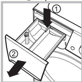
Pentru a scoate sertarul, apăsați pe levierul (1) și trageți-l spre exterior (2) (a se vedea figura).
