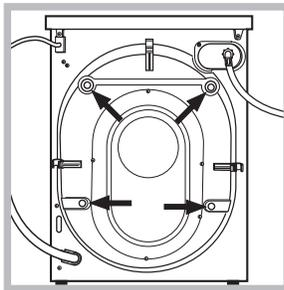
3. Die 4 Transportschutzschrauben ausschrauben und das an der Rückwand befindliche Gummitteil und das entsprechende Abstandsstück abnehmen (siehe Abbildung).
