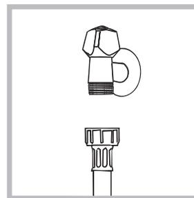
1. Schrauben Sie den Wasserschlauch an einen Kaltwasserhahn mit  $\frac{3}{4}$ -Zoll-Gewindeanschluss an (siehe Abbildung).
